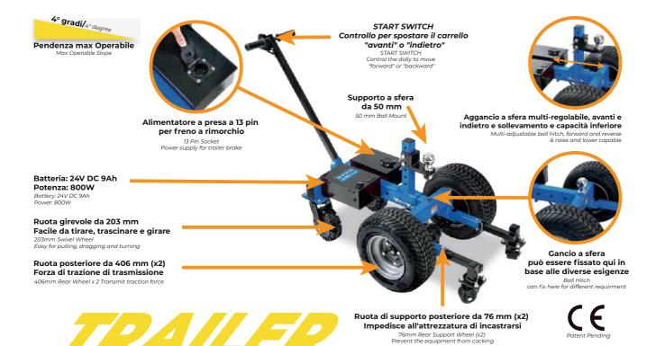
Carrello di traino per rimorchi ad alta capacità, progettato per spostare rimorchi fino a 3400 kg di peso totale e con un massimo di 560 kg di carico sul gancio. Ideale per il movimento sicuro e pratico di camper, rimorchi per il trasporto di merci e rimorchi per imbarcazioni.
